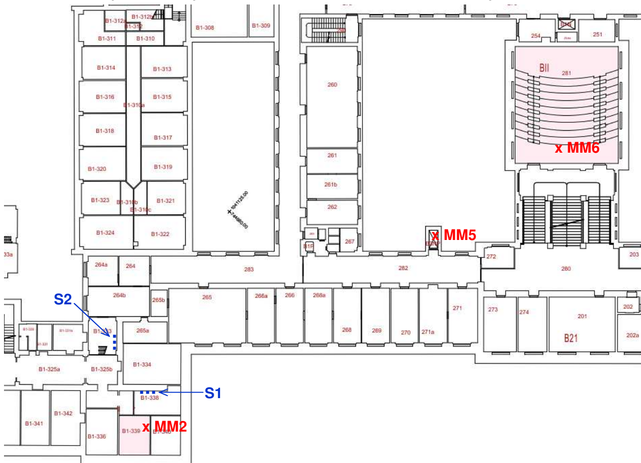
Obr. 3.3: Půdorys 3. NP s vyznačením míst měření a umístěním střelby ve 4. NP
